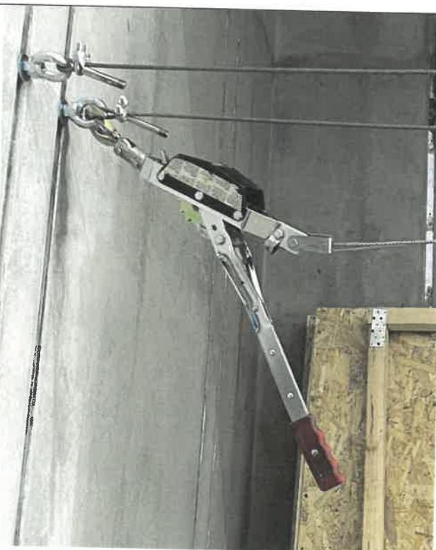
Рисунок 10. Приложение горизонтальной нагрузки на каркас осуществляли посредством ручной лебедки
